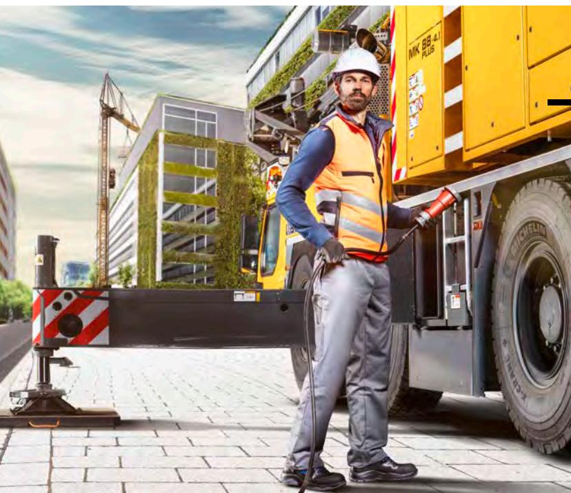
**Elektrisch betriebener Kran mit hybrider Stromzufuhr.
